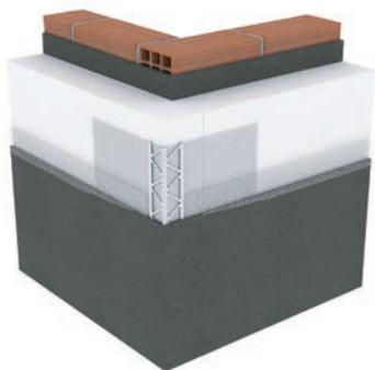
Este tipo de perfil, sirve para reforzar las aristas existentes en la fachada. La manera de colocarlo sería:
