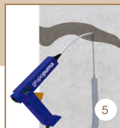
Aplicación Resina inyección epoxi BV .
